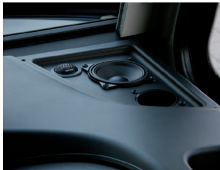
Mittelhochton-System - auf dem Armaturenbrett (Anordnung variiert je nach Modelltyp)
