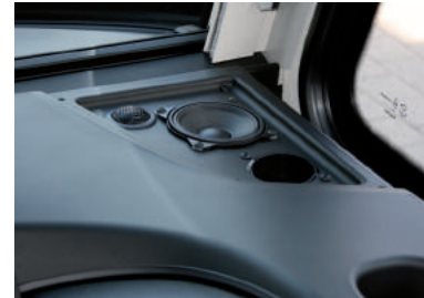
Lautsprecherbestückung auf dem Armaturenbrett (mit und ohne Abdeckblende)
