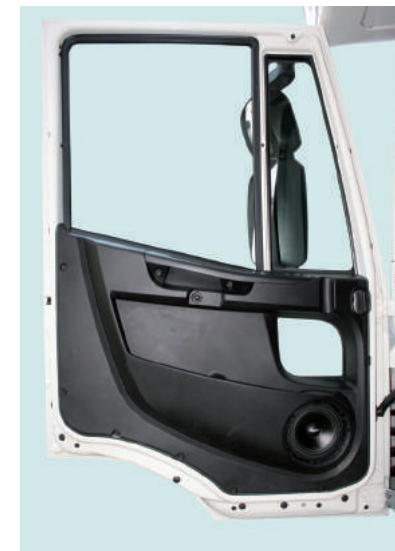
Tieftöner »XM165« im werkseitigen Einbauort der Fahrertüre
