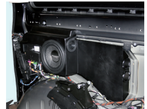
200 mm Quadcoil Subwoofer installiert
