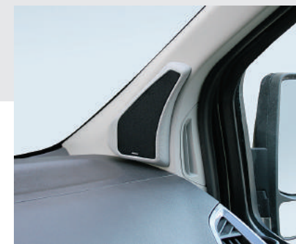
Mittelhochton-Modul an der A-Säule montiert
