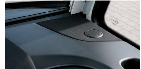
Lautsprecherbestückung auf dem Armaturenbrett (mit und ohne Abdeckblende)
