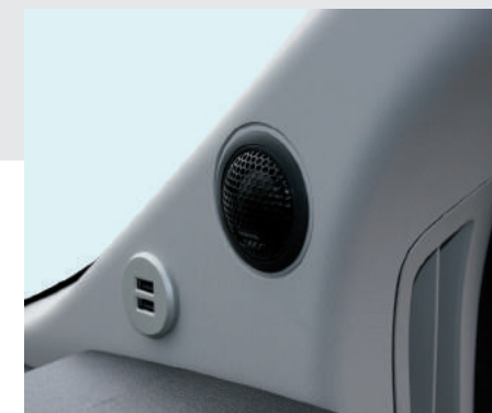
Hochtöner im werkseitigen Einbauort montiert
